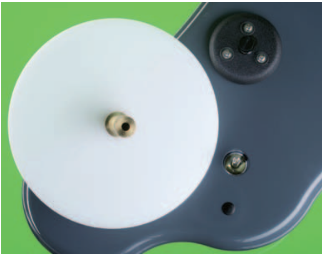
Das zähe Öl fließt durch die Drehbewegung aus der Vorratswanne nach oben in die Bronzebüchse und übernimmt dort die Seitenführung.
