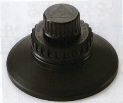
「BFA-CLAMP」の上部のつまみはスピンドルを固定するためのもので、下の大きなノブはレーベル部分の外周部に力を加え押し下げるためのもの
