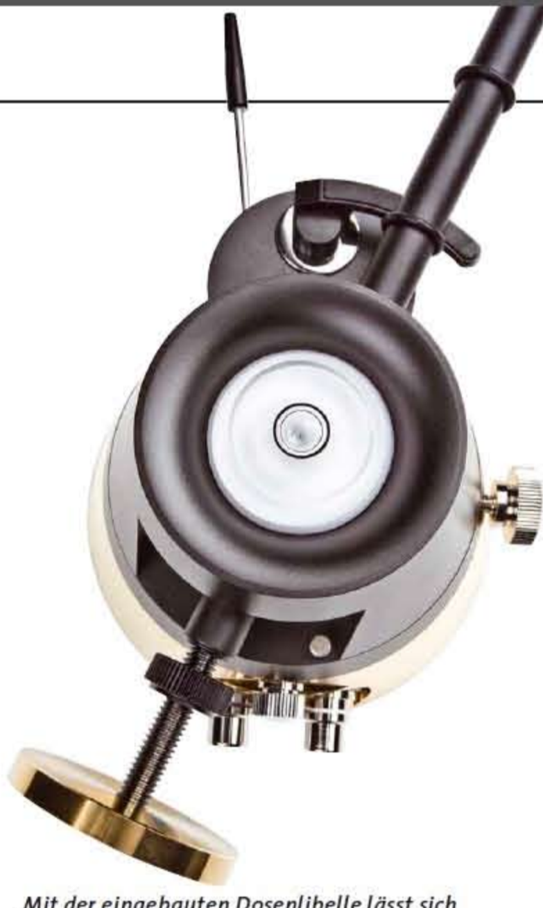
Mit der eingebauten Dosenlibelle lässt sich der Rigid Float bequem in die Waagerechte bringen – den Anschluss zur Außenwelt erledigen zwei solide Cinchbuchsen
